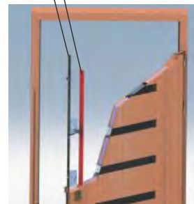
Przekrój przedstawia drzwi wykonane w technologii ramowo-płycinowej (Cuba, Marcel, Grzybek itd.)
